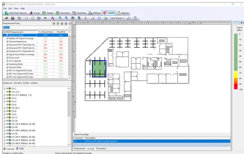
4. Channel/SSIDペインから「Channel」タブを選択します。
