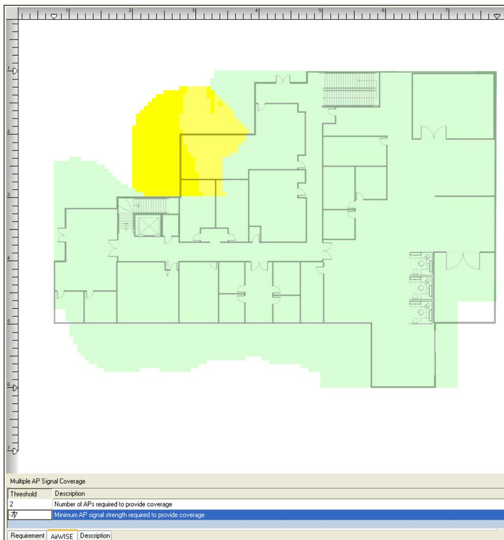
**Note:** 上の図のように、信号強度が  $-77$  dBm に低下すると、WLAN サイトは 91.3% カバーされるようになりました。この結果から、最小信号強度  $-77$  dBm でサイト全体をカバーするには、おそらく 2台の AP を使用できます。
