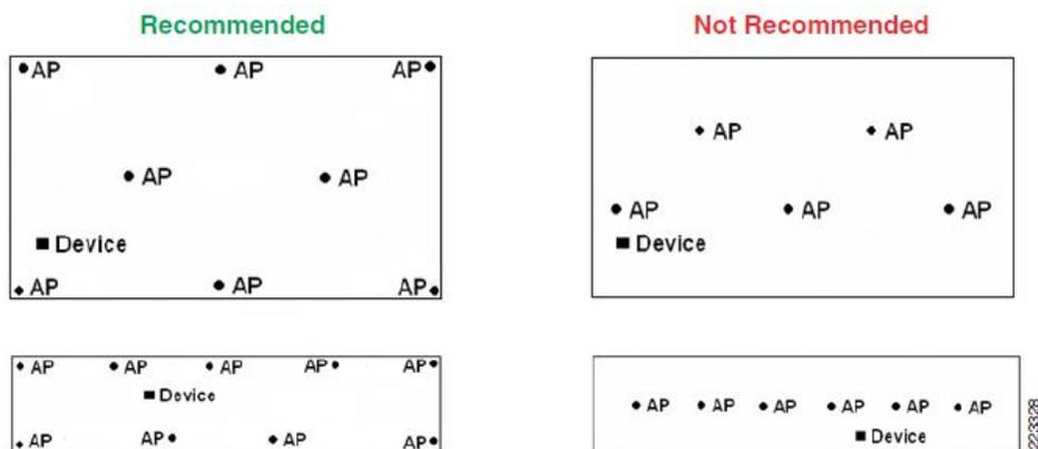
可能であればアンテナは、大きな物体によって至近距離から遮られることなく、周囲 360° を見渡せるように設置してください。例えば、アクセスポイントのアンテナを鉄柱などの大きな物体に直接設置することは可能であれば避けてください。アクセスポイントをアンテナとともに天井に取り付けるという方法もあります(許容可能な取り付け高さが確保できる場合)。もう1つの方法は、アンテナとそのような障害物の間を離すために、短い低損失ケーブル延長を使用することです。
