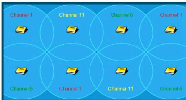
干渉は累積的なものであることに注意してください。いくつかの弱い干渉源が組み合わさって、特定の AP に対して全体的に大きな干渉が発生する可能性があります。このため、AirMagnet Surveyでは、常に単一の AP の観点から干渉の合計を表示します。関心のある AP を選択すると、その単一デバイスの干渉の総分布を確認することができます。
