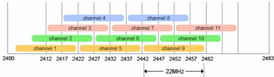
RFチャンネルは正確なエッジを持っていません。20MHzのWi-Fi 4 RF信号の変調された部分は、中心周波数の $\pm 11$ MHzに“収まります”（したがって、22MHzの幅がある）。しかし、いくつかの“ブリードオーバー”、つまり中心周波数の $\pm 30$ MHz（比較的低いパワーレベル）に存在する変調されていないRFエネルギーがある。スペクトラムマスクは、 $\pm 11$  MHzのチャンネル境界の外側にどれだけのRFエネルギーが存在するかを定義します。
