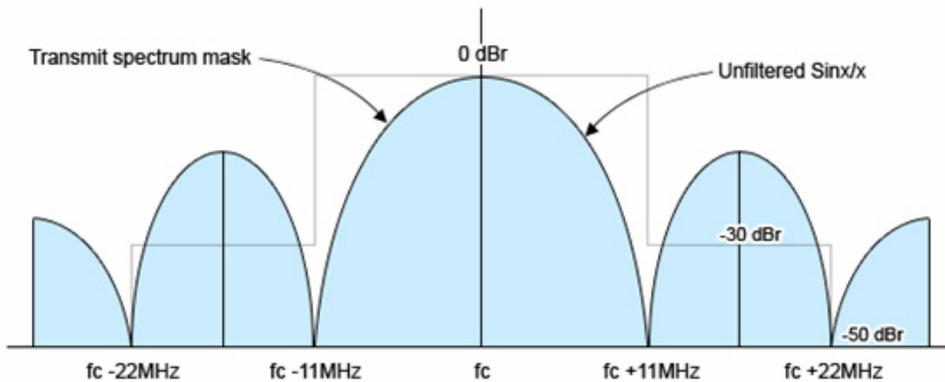
このため、Wi-Fi 4の送信は5つのチャンネル（中央、左隣の2つのチャンネル、右隣の2つのチャンネル）を「占有」します。送信パワーとレシーバーの感度によっては、さらに複数のチャンネル（中央から最大5つ離れたチャンネル）に干渉を引き起こす可能性もあります。
