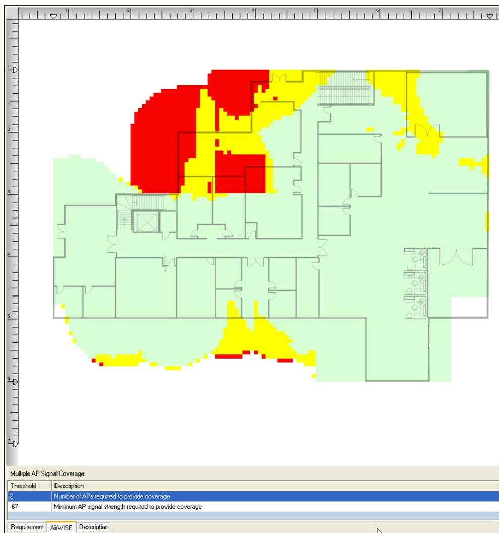
**Note:** 上の図は、収集されたサーベイデータに基づいた、複数のAP信号カバレッジ要件に対するネットワークの準備状況を示しています。サイトの大部分が赤で表示されており、その電波の到達範囲が悪いことを意味しています。この状況を改善するには、既存の AP の信号強度を上げるか、ネットワークから AP を 1つ削除します。以下のステップ 2 ~ 3 は、説明のみを目的としています。
