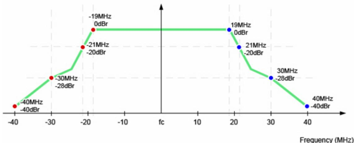
このため、2.4GHz帯で40MHzのWi-Fi 4を送信する場合、9つのチャンネル(中央、左隣4つ、右隣4つ)が使用されます。このため、2.4GHz帯(使用可能なチャンネルは11しかない)で40MHzの伝送を行うと、1回の伝送で同帯域で使用可能な周波数の80%以上を使用することになり、問題が発生する可能性があります。さらに、2.4GHz帯は5GHz帯よりもはるかに混雑しています。これは、Bluetooth機器、電子レンジ、その他の2.4GHz帯の一般的な干渉源とも競合しなければならないためです。共存メカニズムは、この帯域の問題を軽減するのに役立つが、解消することはできません。
