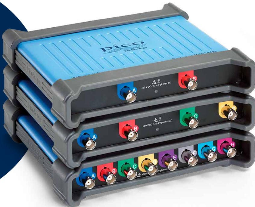
PicoScope 4000A シリーズは、周波数帯域 20 MHz, 低ノイズ12ビット分解能のオシロスコープです。ロング・キャプチャ・メモリで、ファンクション・ゼネレータおよび任意波形発生器を内蔵しています。
