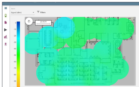
分析のためクラウドベースのLink-LiveServiceまたはAirMagnetSurvey PROでサーベイデータを可視化します。
