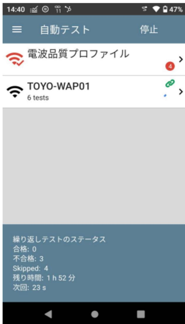
繰り返し自動テストの結果は、自動テスト画面の下部にまとめて表示されます。合格と不合格は、個々のプロファイルではなく、プロファイルグループ全体の各実行について報告されます。次の時間間隔が発生したときに前の時間間隔のテストがまだ実行されており、次の実行を開始できない場合は繰り返し自動テストはスキップされます。
