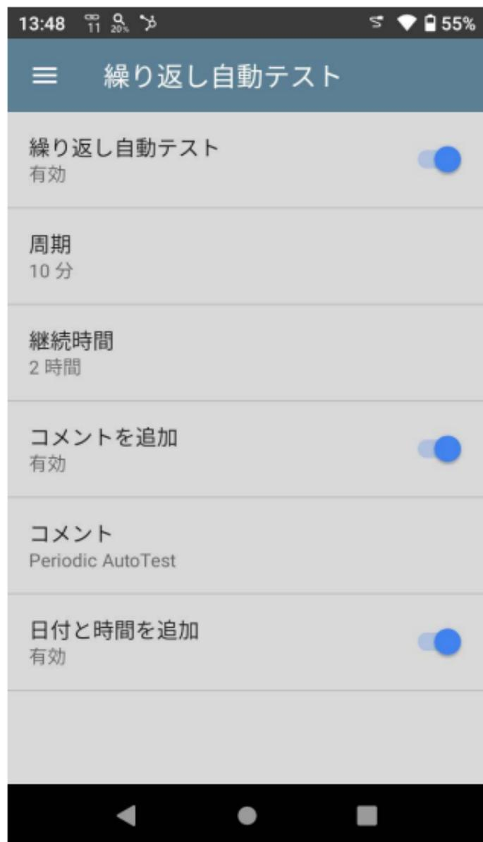
**繰り返し自動テスト**フィールドをタップして有効にし、必要に応じて以下の設定を調整します。
