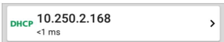
DHCPテストカードには、DHCPサーバーのIPアドレスと、検出、オファー、要求、および確認が完了するまでの合計時間が表示されます。
