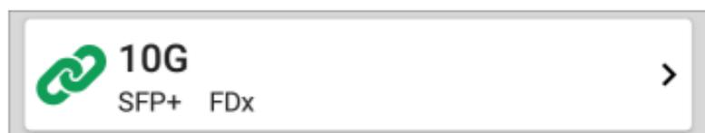
ファイバ接続の場合、リンクテストカードには接続速度とデュプレックスが表示されます。
