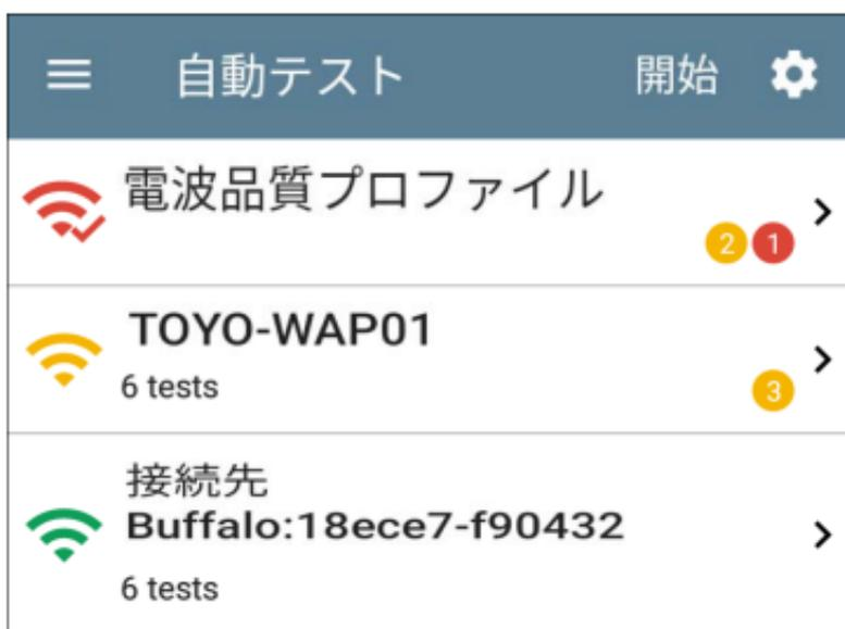
自動テスト画面には、プロファイル、テスト、または測定の種類に対応するアイコンが表示されます。実行後、これらのアイコンは色が変わり、テストのステータスを表します:
