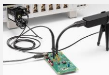
IsoVu絶縁型プローブ
